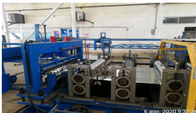
Foto N.º 7.5. Producción de techo Zinc de 11 ondas
