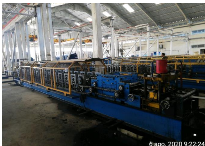
Foto 3. Área de Producción, Formadora de Paneles de Losa
